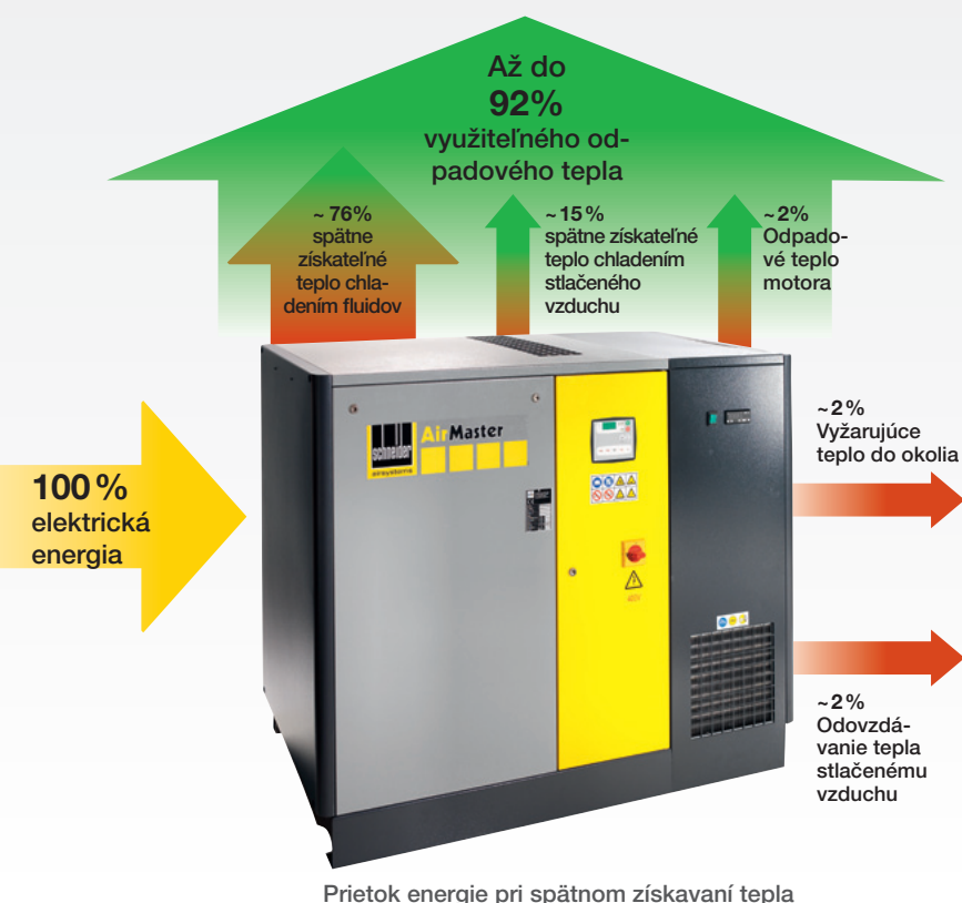
Prietok energie pri spätnom získavaní tepla
